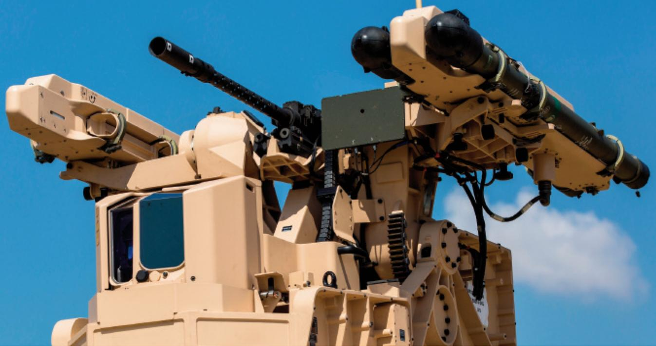
Für die Fähigkeit zur bodengebundenen Luftverteidigung im Nah- und Nächsbereich bietet MBDA ein System, welches die Flugabwehr von der Fahrzeugkante bis jenseits der 20 Kilometer gewährleistet. Das System zum Nah- und Nächsbereichsschutz (NNbS) stellt neben TLVS ein weiteres Element der integrierten Luftverteidigung dar.
