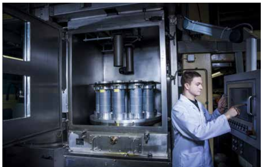
Vorbereitung für das Gießen von Explosivstoff in die Gefechtskopffgehäuse
