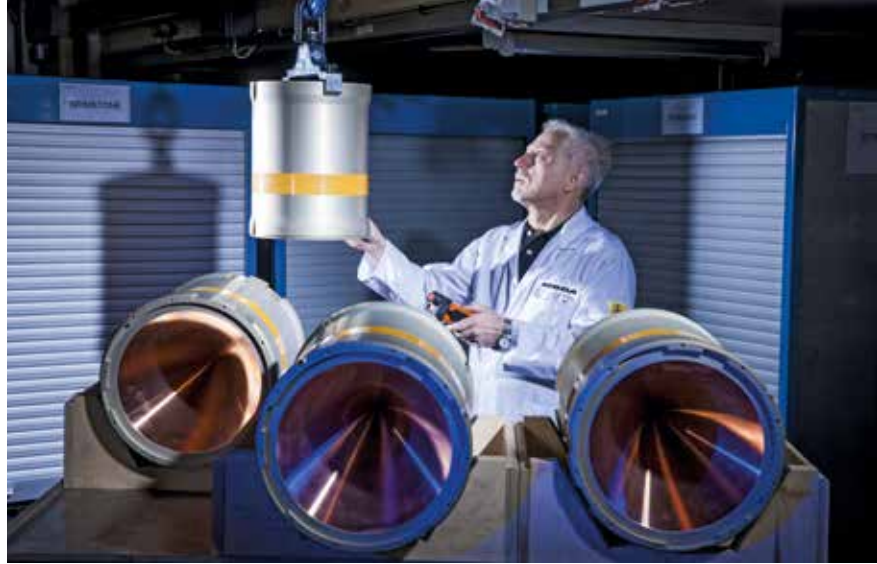
Abschließende Inspektion der montierten Hohlladungs-Gefechtsköpfe
