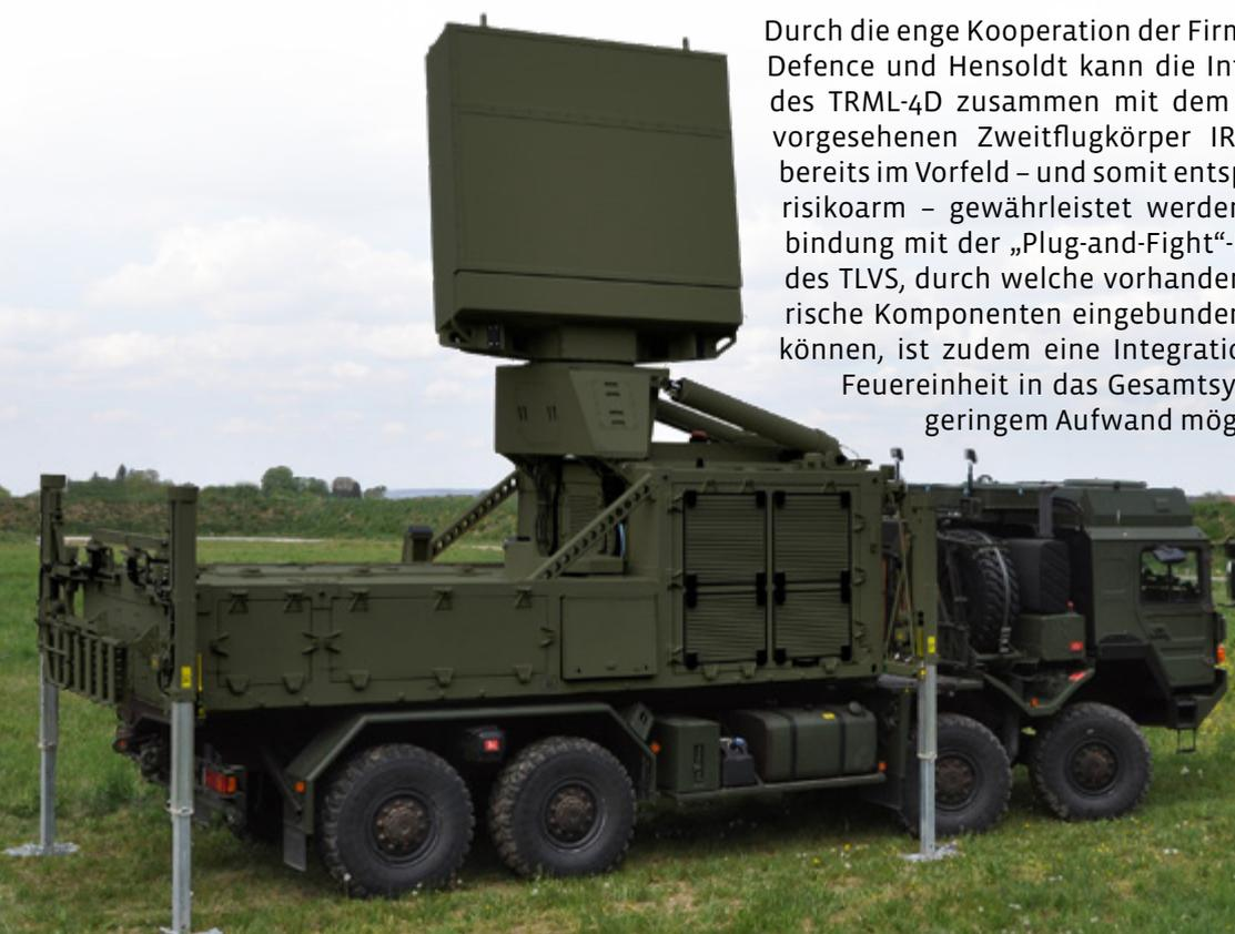
Die Leistung des Radars selbst ist dabei für genau solche Einsatzszenarien abgestimmt: Detektionsreichweite, Azimut- und Elevationsabdeckung, Zielgenauigkeit sowie die erreichbare Aktualisierungsrate des Luftlagebildes erlauben eine optimale Nutzung der IRIS-T SLM und weiterer Effektoren gegen moderne, hochagile Luftziele aller Art. Dabei erfüllt das TRML-4D sämtliche TLVS-Mobilitätsanforderungen und ist für alle vorgesehenen Klimazonen qualifiziert.
