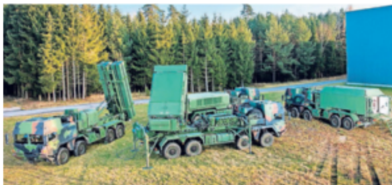
Das Taktische Luftverteidigungssystem TLVS, hier als Prototyp mit einem Radarsystem (Mitte), einem Raketenwerfer (links) und einem Gefechtsstand (rechts) für die Soldaten. FOTO: BERNHARD HUBER/MBDA
